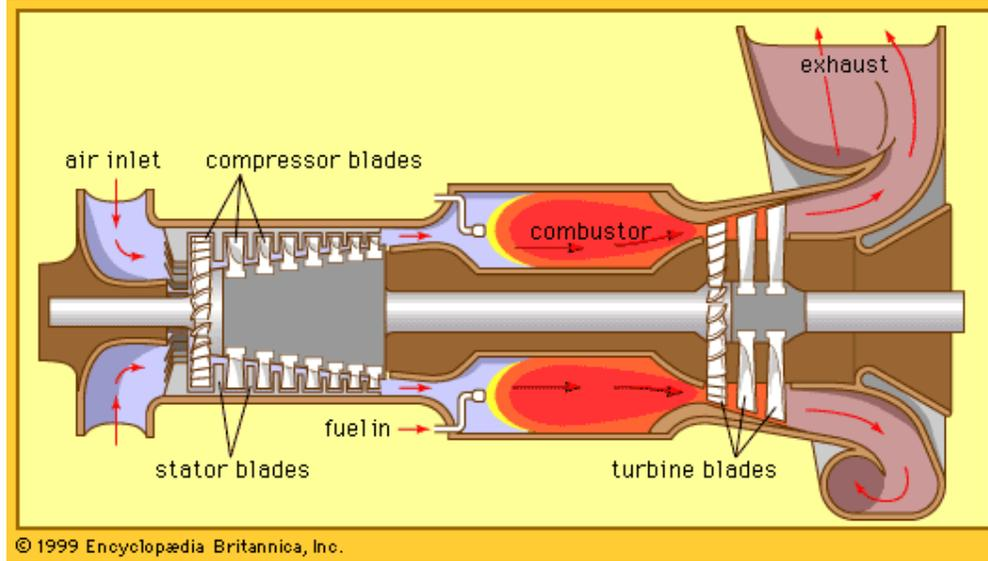
عند دخول الغاز المتمدد الى التوربين, يحصل تمدد للغاز بين زعانف التوربين ولتي تصل درجة حرارتها الى 1000 درجة مئوية و من ثم يتحرك التوربين و يتم الدوران التي تصل سرعتها الى 3000 لفة في الدقيقة ( RPM 3000 )
